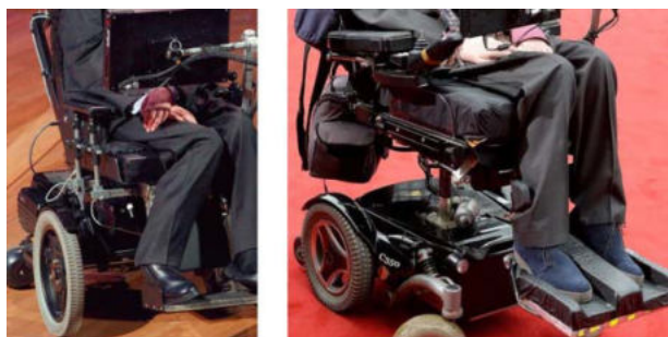
Рис. 2. Подножки колясок знаменитого физика Стивена Хокинга: а – типовой формы; б – фиксирующая положение ног [7]
