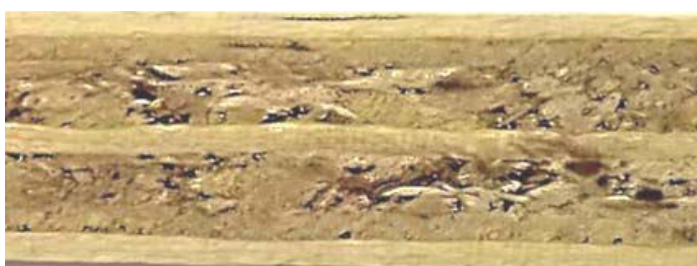
Рис. 4. Схема сборки композиционной фанеры, удовлетворяющая условиям максимизации прочностных показателей
