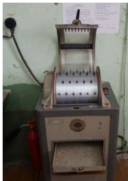
Рис. 2. Лабораторное средство ПК-2М для определения массовой доли костры в короткой пеньке
