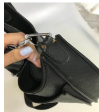
Рис. 5. Разрыв узла крепления ручки на сумке Hermes
